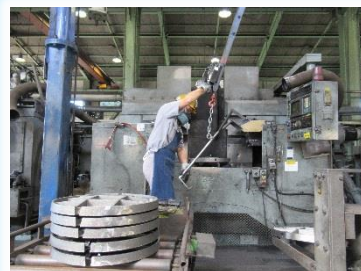
▲機械で外周部を加工
