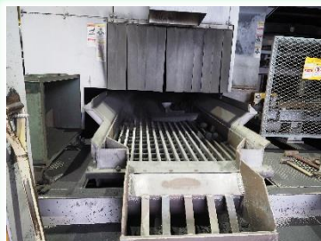
▲振動で鑄型を壊す工程
