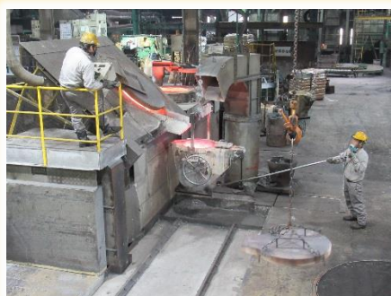
▲電気炉で溶かした鉄を取鍋へ
