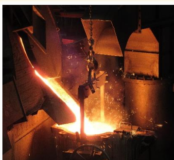
▲電気炉で溶かした鉄を取鍋へ
