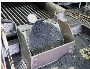
▲振動で鑄型を壊す工程
