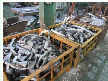
▲湯口などの不要な部分は再利用
